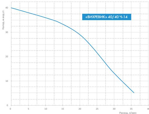
на выходе насоса не должно превышать 5,5 бар. Для соблюдения этого ограничения рекомендуется установить редуктор давления перед входом в насос. При этом расходно-напорная характеристика насоса изменится в большую сторону.
